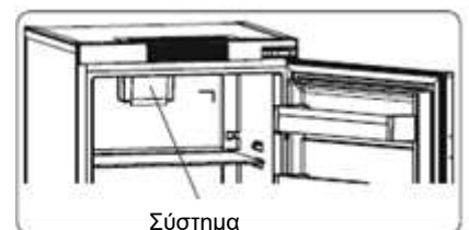
Σύστημα ανακυκλοφορίας αέρα
